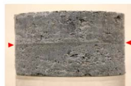
③ すべり面が水平となるように円柱状供試体を成形
