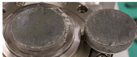
⑤ 試験後にせん断面を観察し、すべり面とせん断面位置の一致を確認
