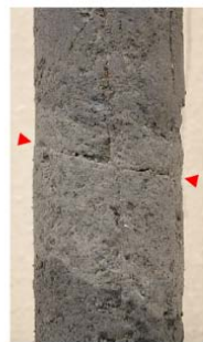
① ボーリングコアにすべり面を確認
