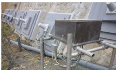
アンカー荷重計測事例
